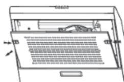
2. Colocar la campana en la pared y marcar con un lápiz los 4 puntos donde se harán los barrenos (2 por lado).
