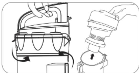
4.- Si queda polvo atascado en la parte superior de la copa, desenrosque en sentido contrario a las manecillas del reloj. Retire la tapa jalando la cabeza de la copa ciclónica, retire el polvo y asegure nuevamente la tapa.
