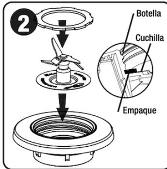
2. Coloque la cuchilla en la interfase posteriormente coloque el empaque de silicón como se muestra en la figura 2, de tal forma que el empaque detenga la caída de las cuchillas.
