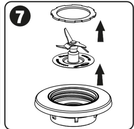
7. Para desmontar las espas de la interfase primero se debe de retirar el empaque cuidadosamente, el empaque se retira muy fácilmente solo muévelo hacia arriba, posteriormente se retiran las cuchillas. Hágalo con precaución, las cuchillas son filosas.
