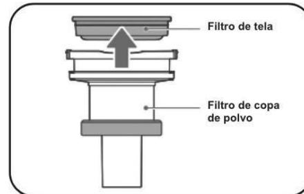
Retire el conjunto del filtro; luego retire el cono de ciclón y límpielo; móntelo de acuerdo con los pasos de desmontaje después de que cada pieza se haya secado completamente.
