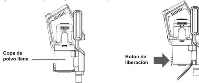
2. Desmonte la copa para el polvo después de colocar la máquina en posición horizontal, presione el botón de liberación y retire la copa para el polvo en la dirección de la flecha.
