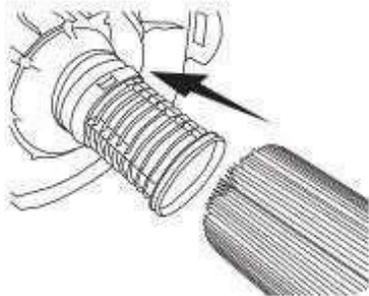
1. Coloque el filtro plisado en la jaula, empuje el filtro hacia adentro hasta que pare contra la pared inferior de la cabeza.
