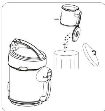
3. Presione el botón de liberación automática para vaciar el polvo y desecharlo.
