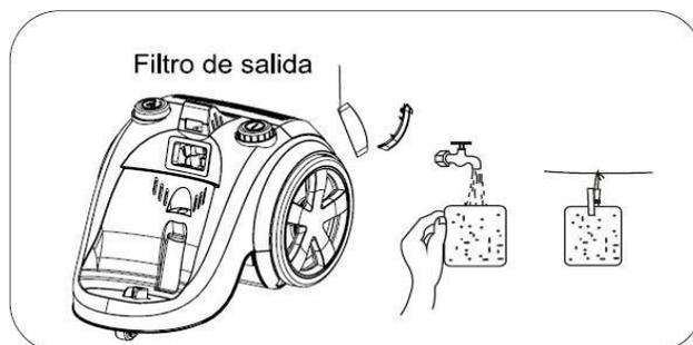
1.- Saque el filtro de salida, sacudir o lavar con agua, dejar secar completamente por 24hrs. y colocarlo en su lugar.
